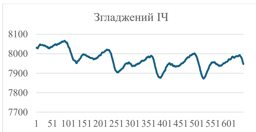
Рисунок 3.2.3 – Фрагмент графіку сигналу з декількома послідовними циклами, отриманий при частоті дискретизації у 200 Гц
