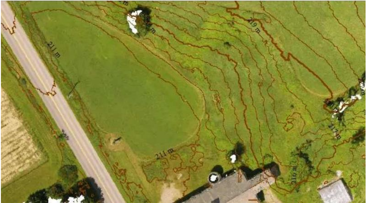
Рис.2.3 Global Mapper Pro надає можливість створювати контурні лінії на основі рельєфних даних або хмари точок.
