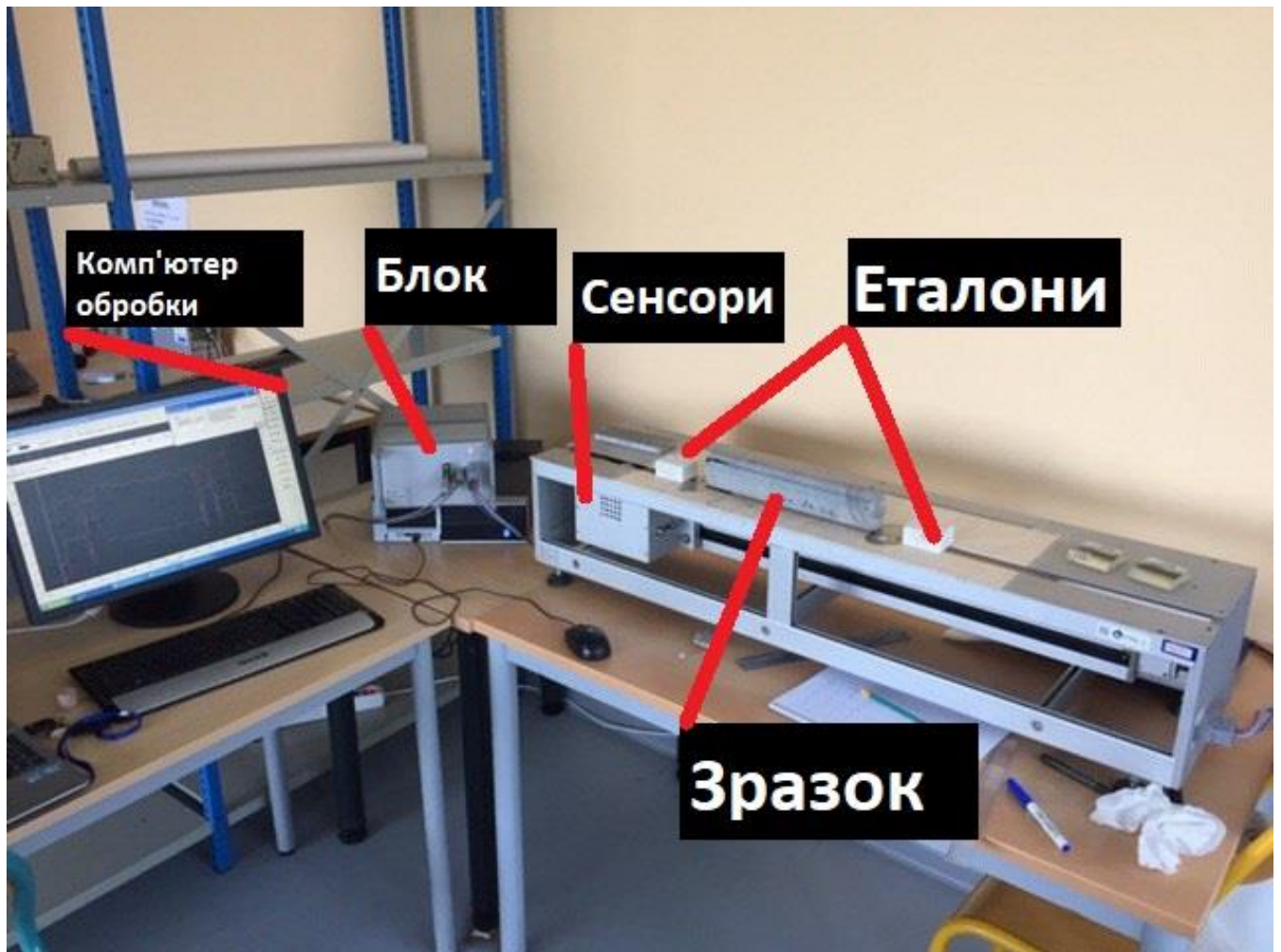
Рис. 5.2. Установка Thermal Conductivity Scanner (TCS) для вимірювання термічних параметрів зразків
