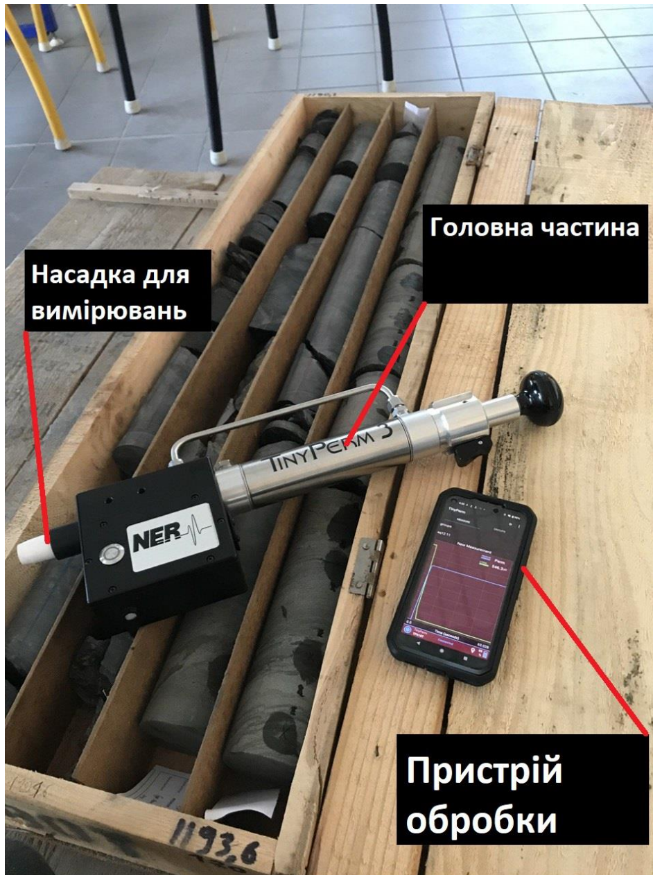
Рис. 5.3. Установка TinyPerm3 для вимірювання проникності на зразках
