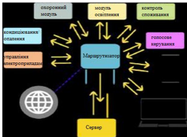
Рисунок 1.2 – Принцип побудови системи «розумний дім» з бездротовим маршрутизатором або модемом
