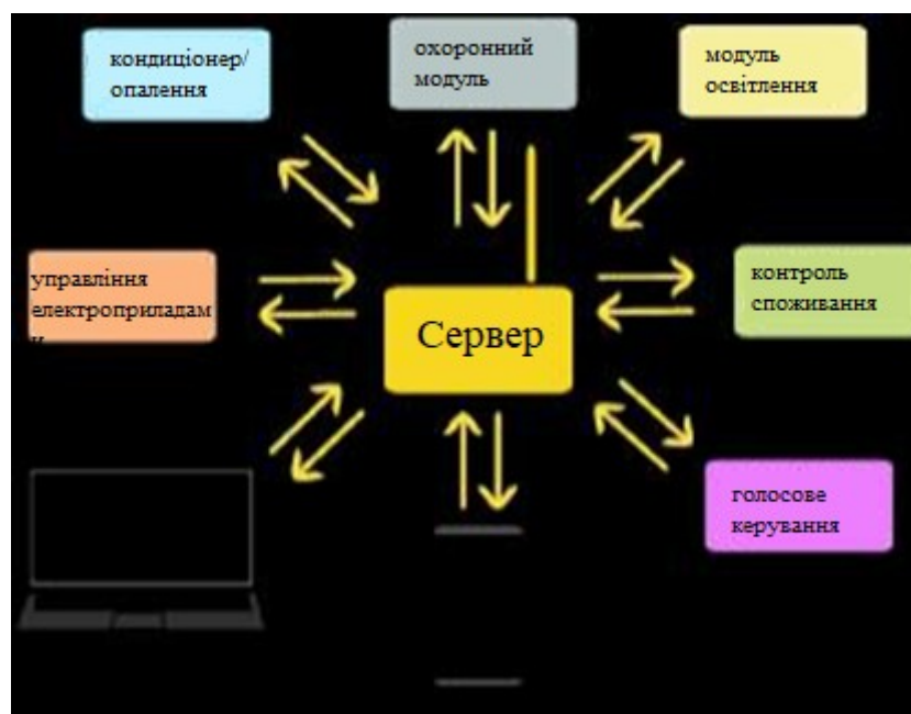
Рисунок 1.3 – Принцип побудови системи «розумний дім» із сервером у режимі програмної точки доступу
