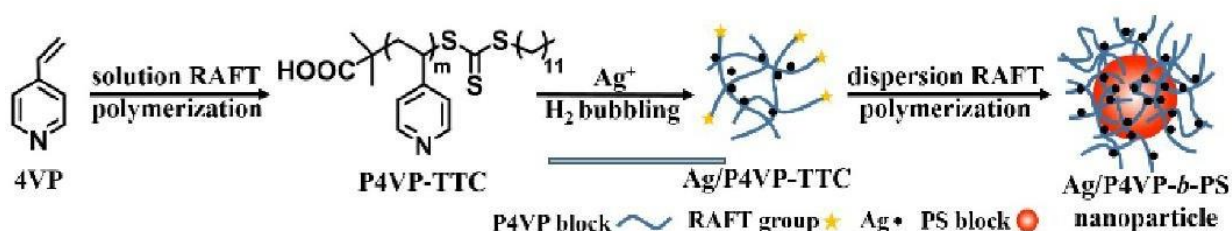
Схема 11. Синтез полі-4-вінілпиридинового макро -RAFT агента і метало-полімерних композитних наночастинок складу Ag/полі-4-ВП-блок-ПС.
