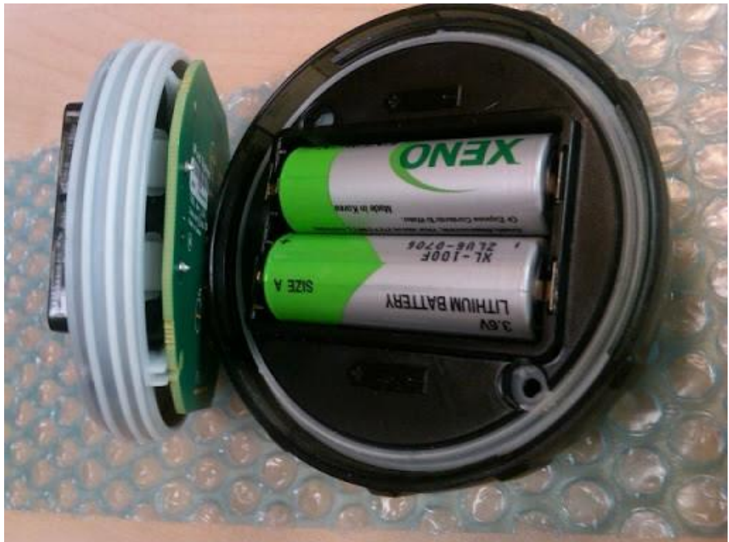
Рисунок 3.2.12 Активна RFID мітка
