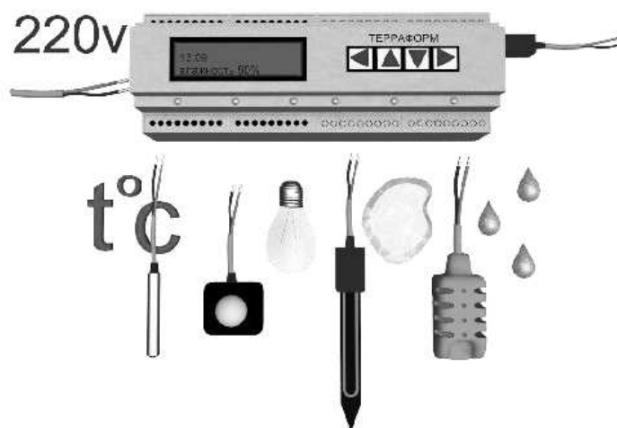
Рисунок 1.5 – Система клімат контролю для теплиць [31]
