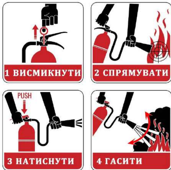
Рис. 4.9. Алгоритм гасіння вогню
