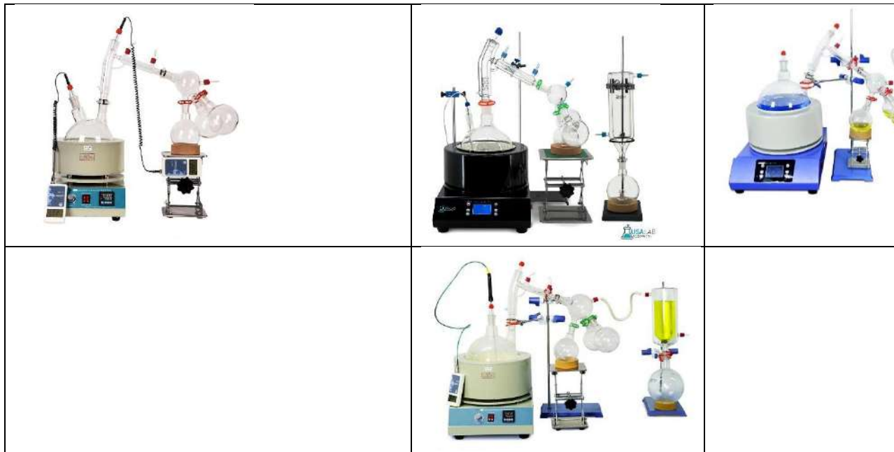
Рис. 8.6. Варіанти збирання вакуумних ліній
