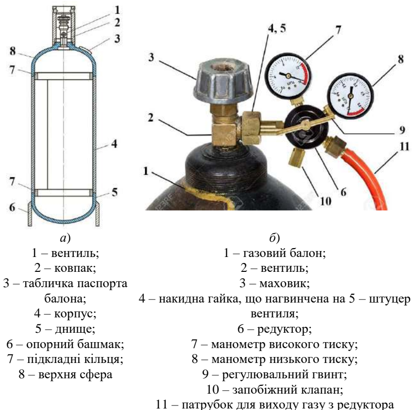
Рис. 9.1. Конструкція газового балона (а). Схема приєднання редуктора до газового балона (б)
