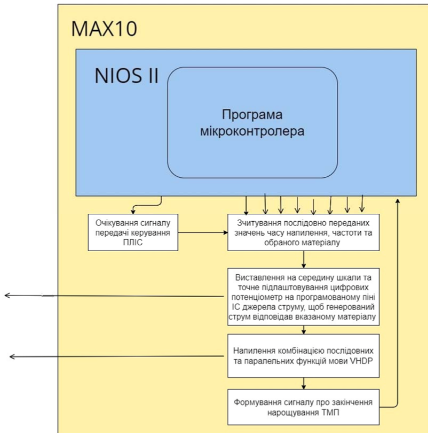
Рисунок 3.12. Структурна схема коду для ПЛІС
