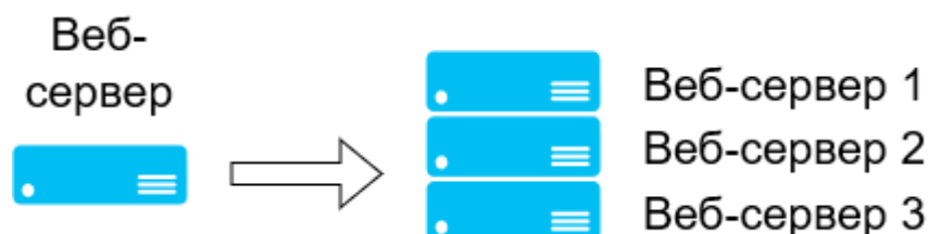
Рисунок 1. Схема горизонтального масштабування
