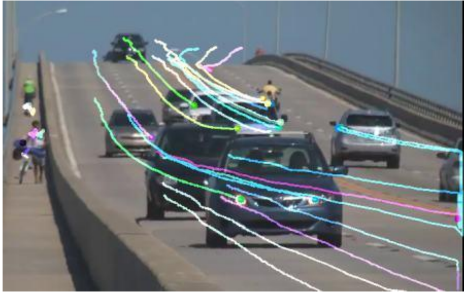
Рисунок 4 – Знаходження оптичного потоку на кутових точках зображення.
