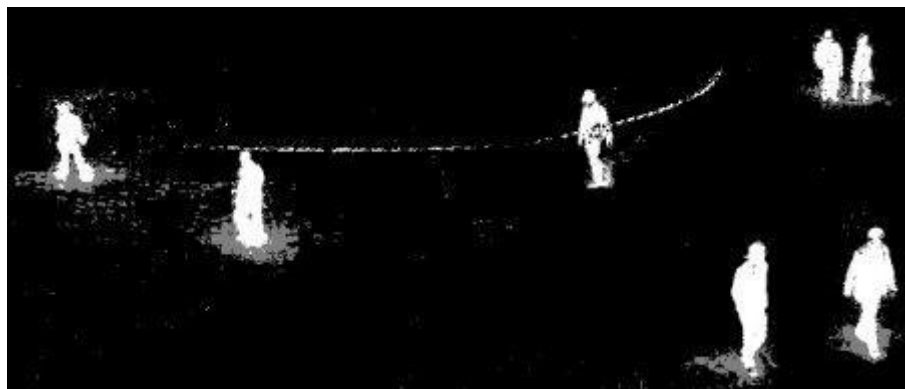
Рисунок 8 – Результат алгоритму BackgroundSubtractorMOG2. Сіра область вказує на наявність тіні.
