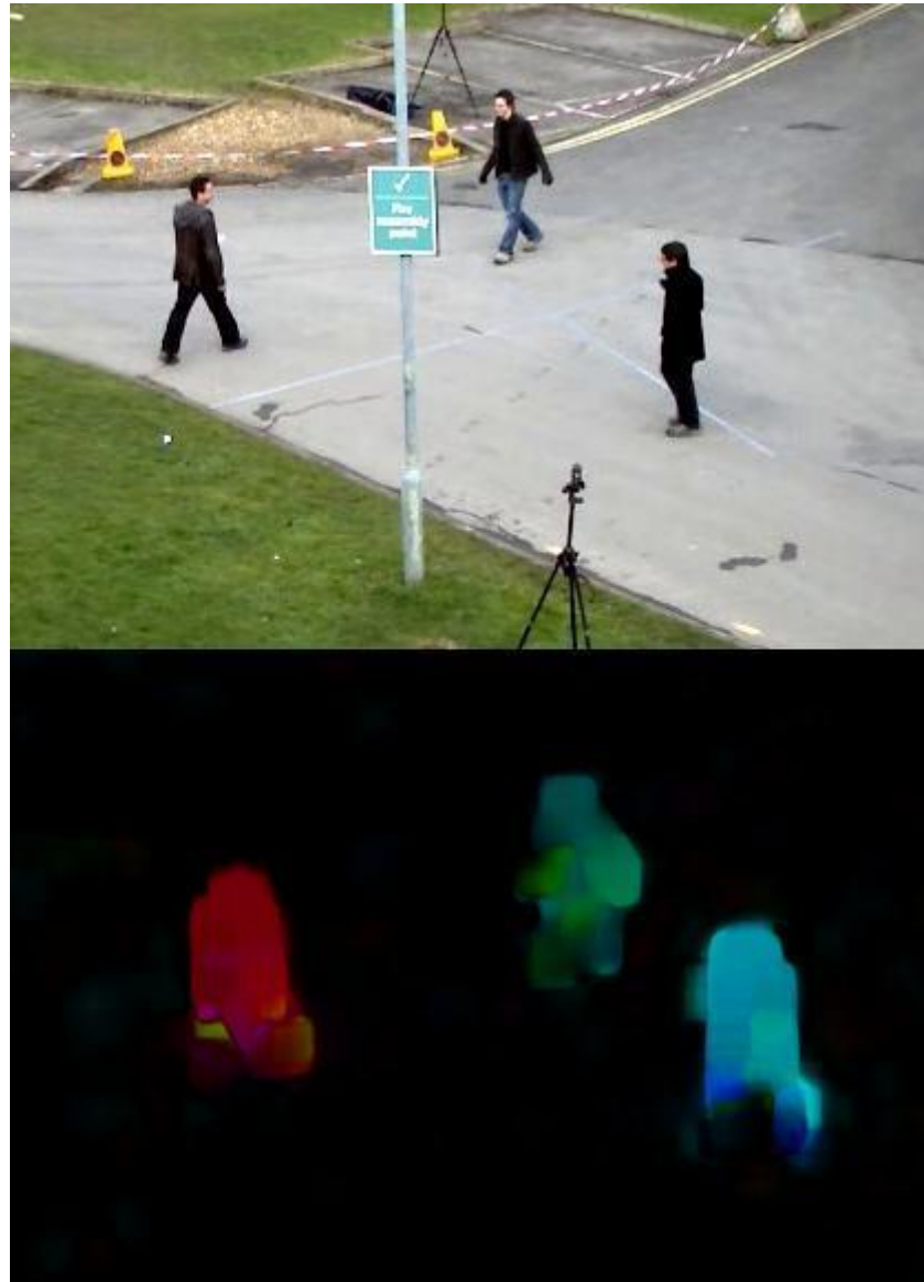
Рисунок 5 – Щільний оптичний потік методом Фарнебека.
