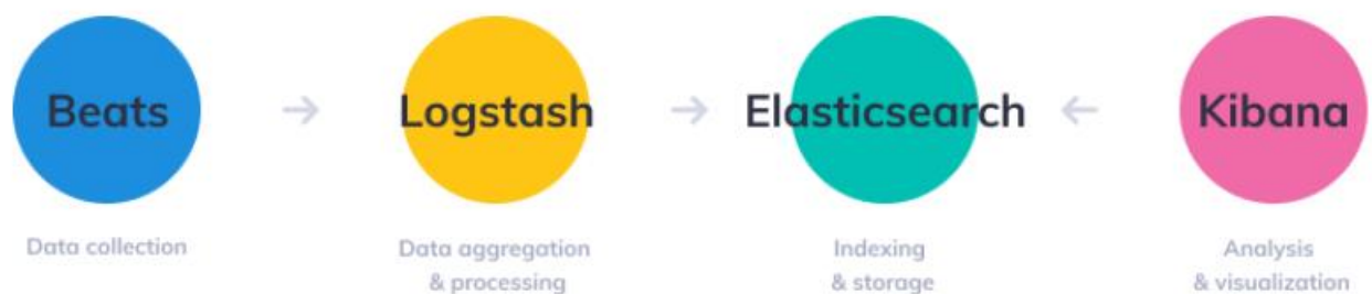
Рисунок 2.2 – Принцип роботи ELK стеку.
