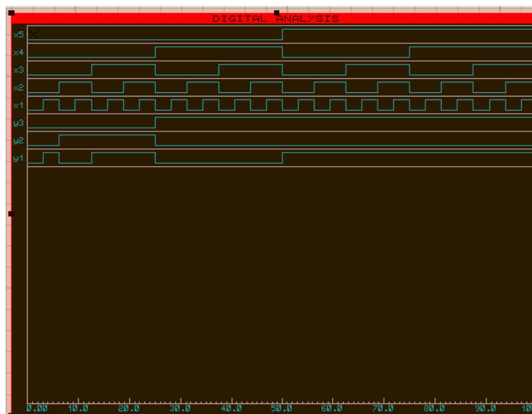
Рисунок 39. Результат роботи пріоритетного шифратора в Proteus
