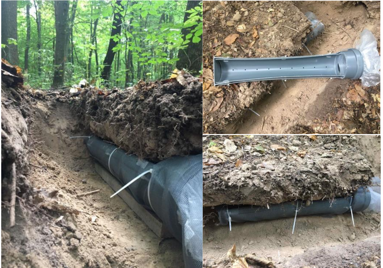
Рис. 2.2. Конструкція та спосіб закладання стаціонарних тарілчастих лізиметрів з нульовою напругою (zero-tension pan lysimeter)
