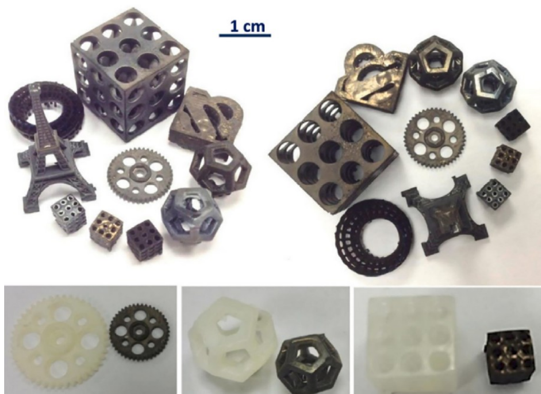
Рисунок 1.3. Кераміка виготовлена методами адитивного виробництва/3D-друку [23].
