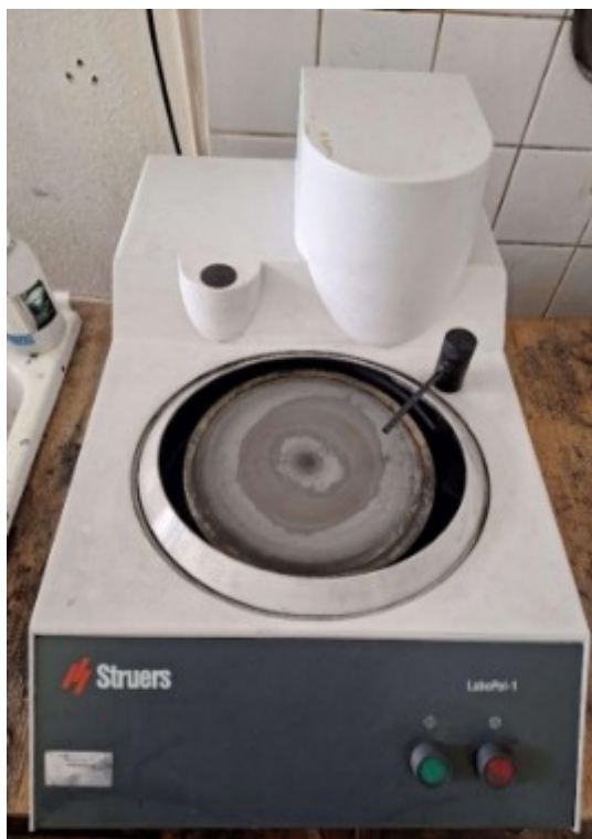
Рисунок 2.3. Установка для поліровки Struers LaboPol-1
