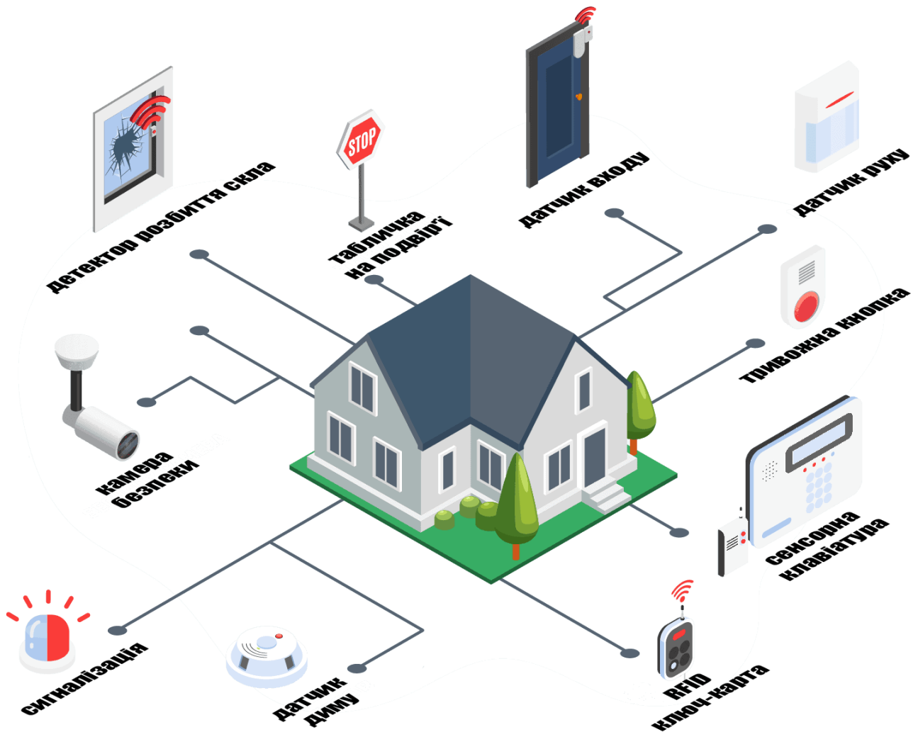
Рисунок 2.1 – Приклад з декількох девайсів що утворюють систему захисту
