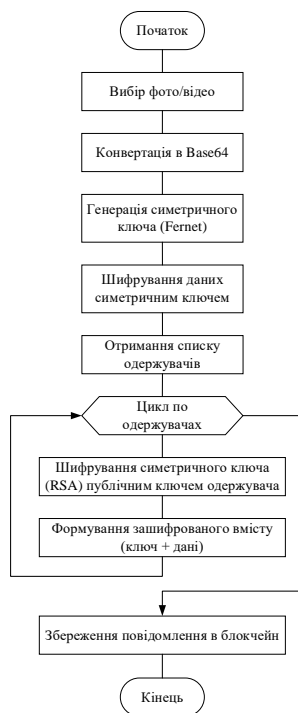
Рисунок 3.2 – Алгоритм шифрування мультимедійного повідомлення з використанням гібридного підходу (Fernet + RSA)
