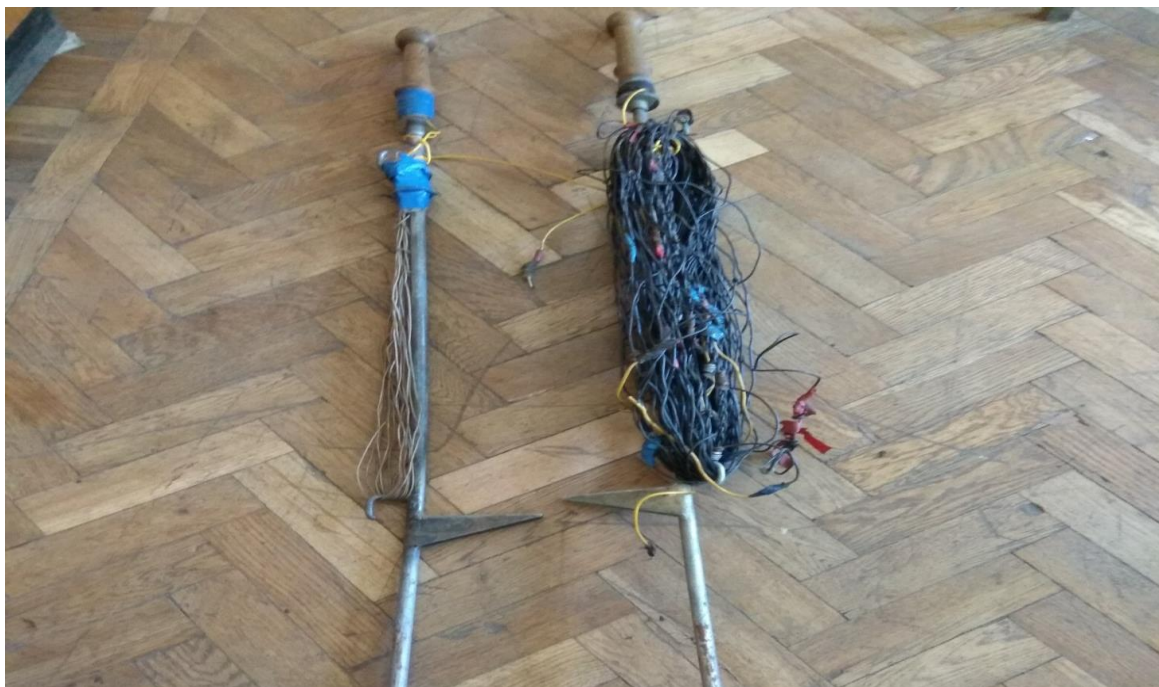
Рис.3.9. Живильна лінія АВ та вимірювальна лінія MN.
