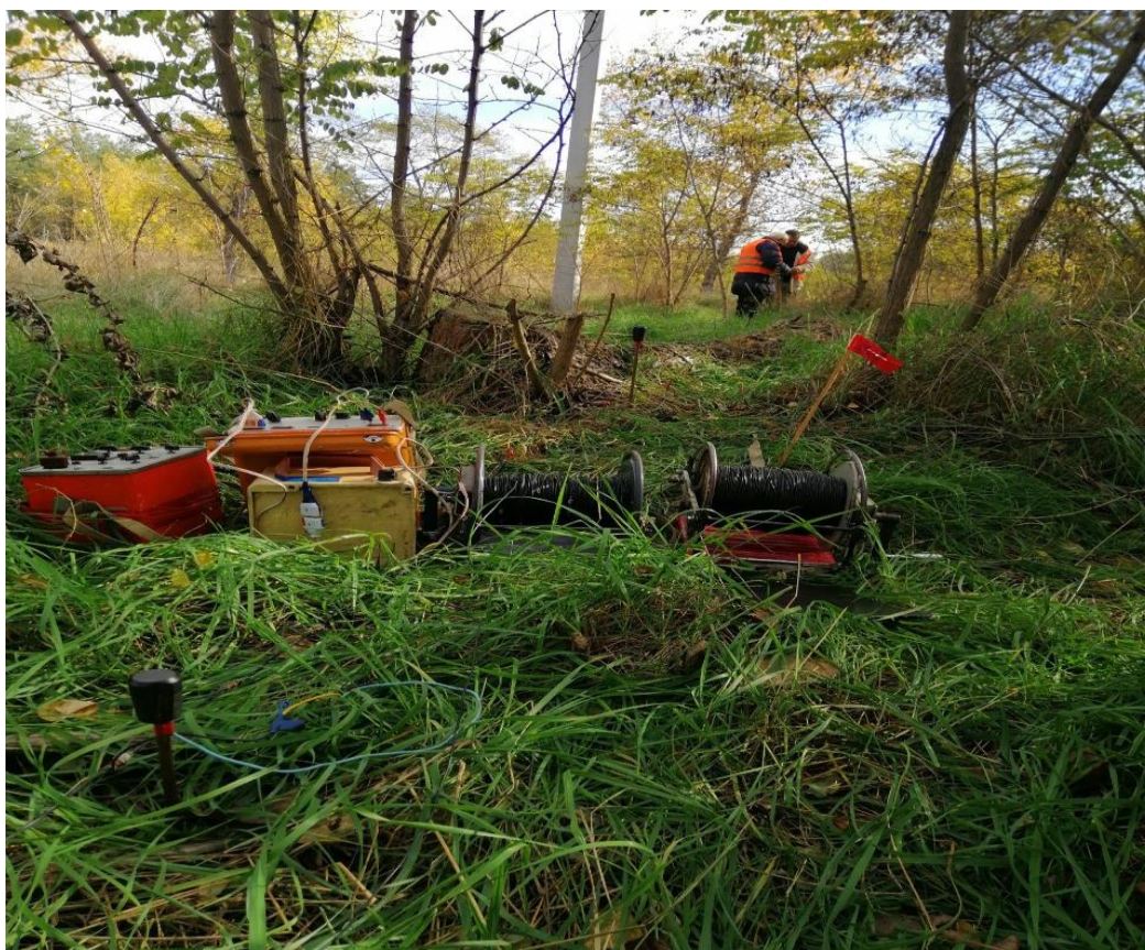
Рис.3.10. Фото проведення ВЕЗ на профілі
