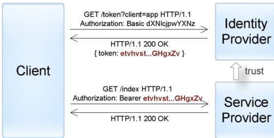
Рисунок 1.6 – Схема аутентифікації “активного” клієнта за допомогою токена
