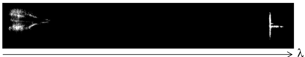
Рис. 5.13. Спектр W_{\omega x} \{z = L\} випромінювання лазера й антистоксової компоненти, що зареєстрований з площини вихідної межі кювети з толуолом.
