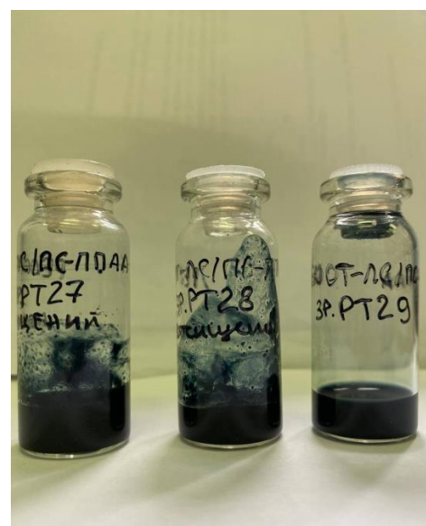
Рис.21. Зразки дисперсій РТ27-РТ29 ПС/ПНІПАМ/ПЕДОТ у воді після діалізу 24 години.
