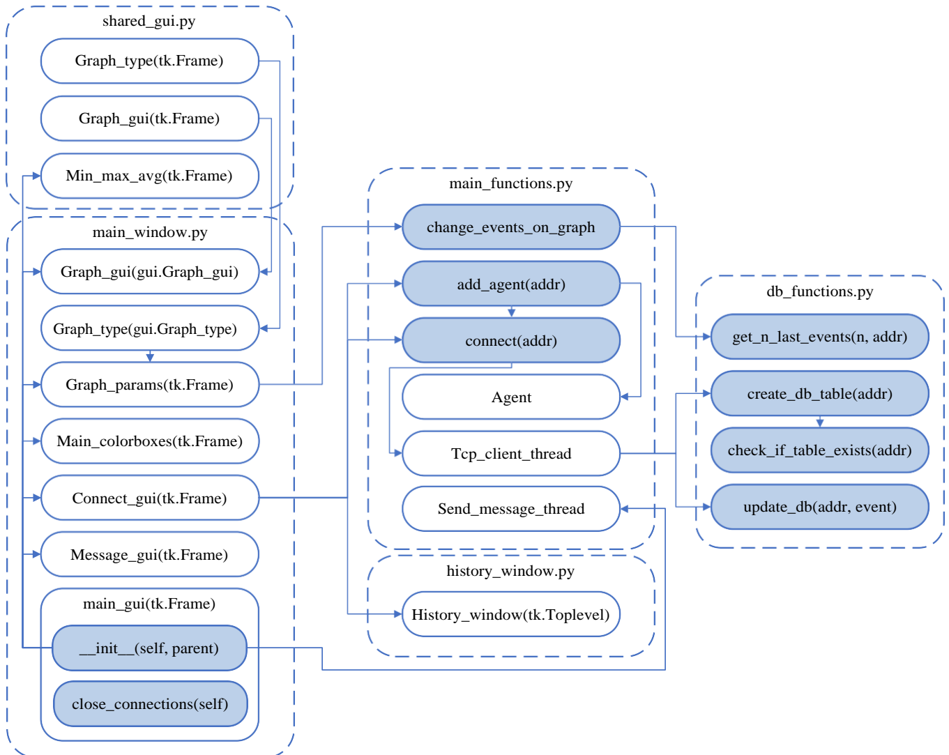
Рисунок 3.9 – Класи та функції головного вікна
