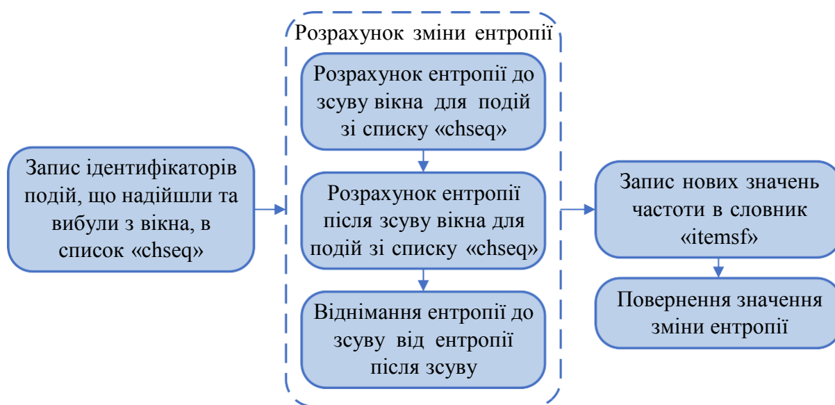
Рисунок 3.5 – Схема роботи функції «calcdH»
