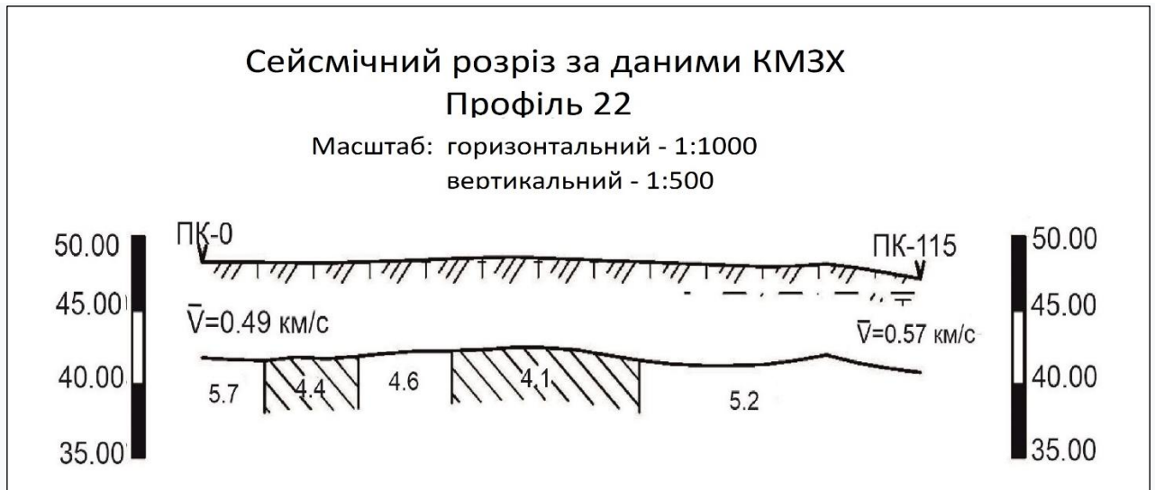
Рис. 3.3 – Приклад сейсмічного розрізу, побудованого за даними КМЗХ
