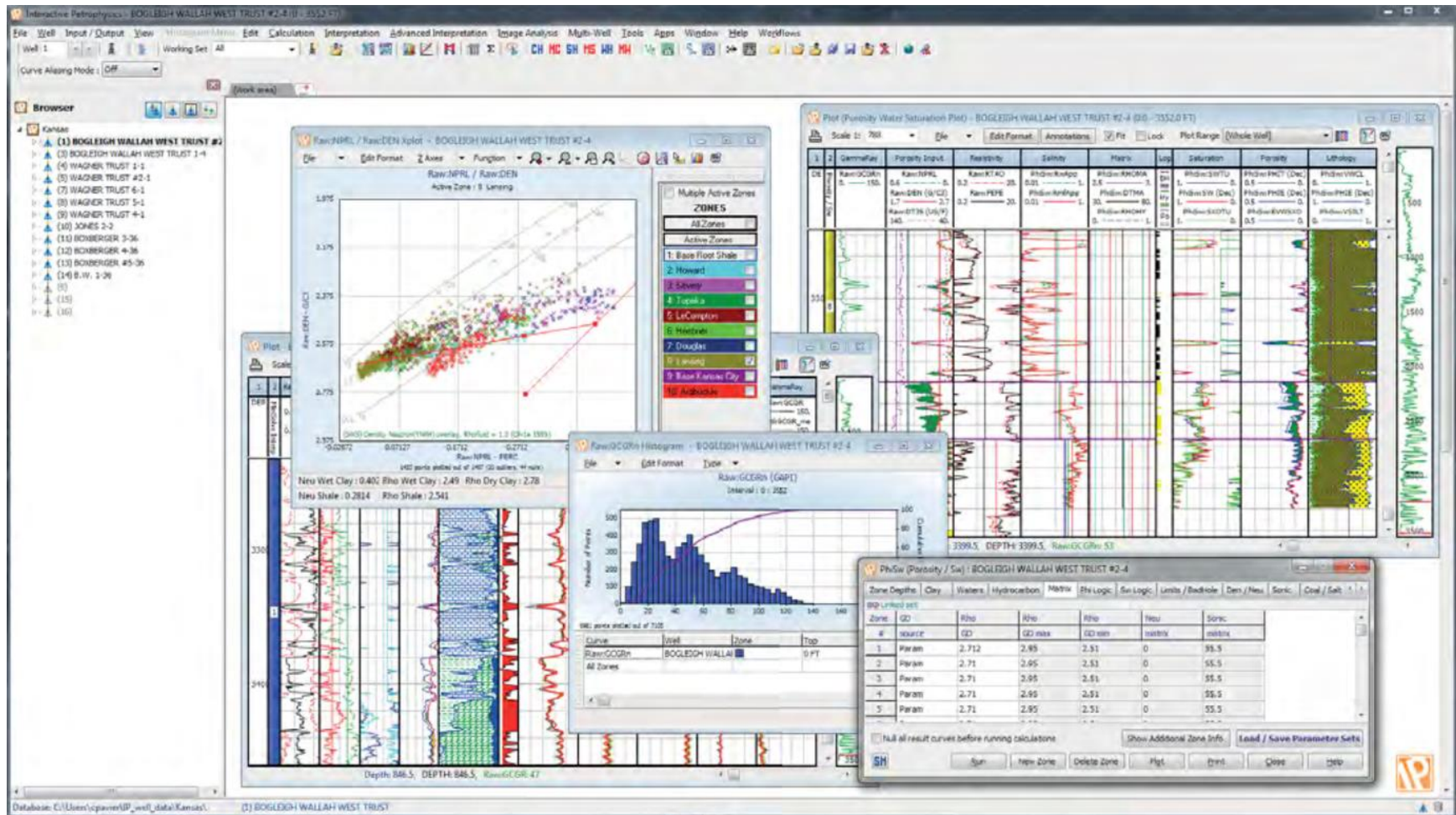
Рис.3.2 – Програмне забезпечення Interactive Petrophysics та його можливості для обґрунтування ефективності породи-колектора (Interactive Petrophysics V3.6 Online Help,2010)
