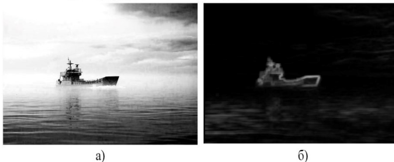
Рис. 9. Оброблення зображення через виділення контурів об'єктів на зображенні: а) початкове зображення; б) зображення, оброблене запропонованим методом
