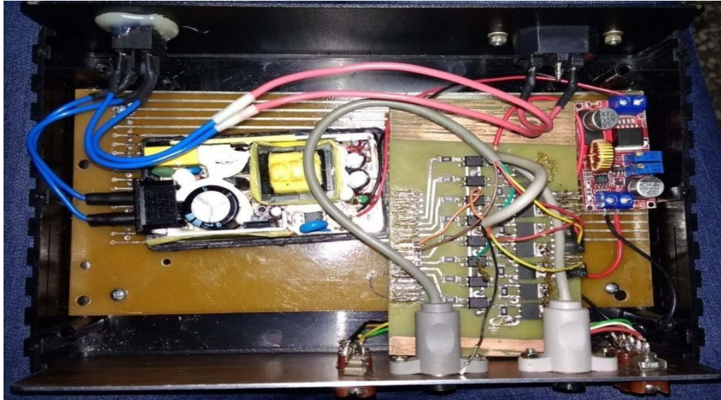
Рис.2.2. Фотографія блоку нового блоку керування кроковими двигунами (плата Arduino UNO знаходиться під платою ключів праворуч)
