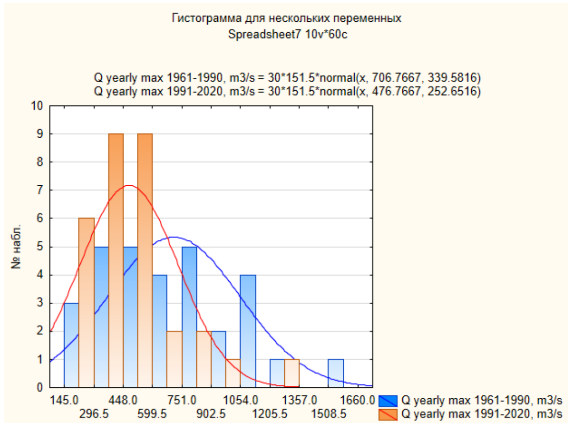
Рис. 4.10. Гістограми статистичного розподілу різних фракцій максимальних витрат води у різних періодах спостережень
