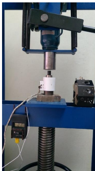
Рис. 2.7. Фотографія пресу для гарячого ущільнення композитних зразків
