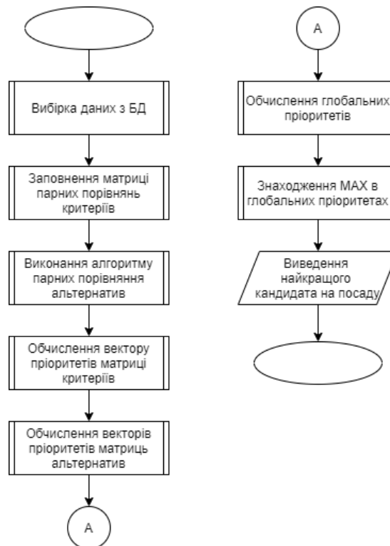
Рисунок 2.5 – Узагальнена схема алгоритму МАІ
