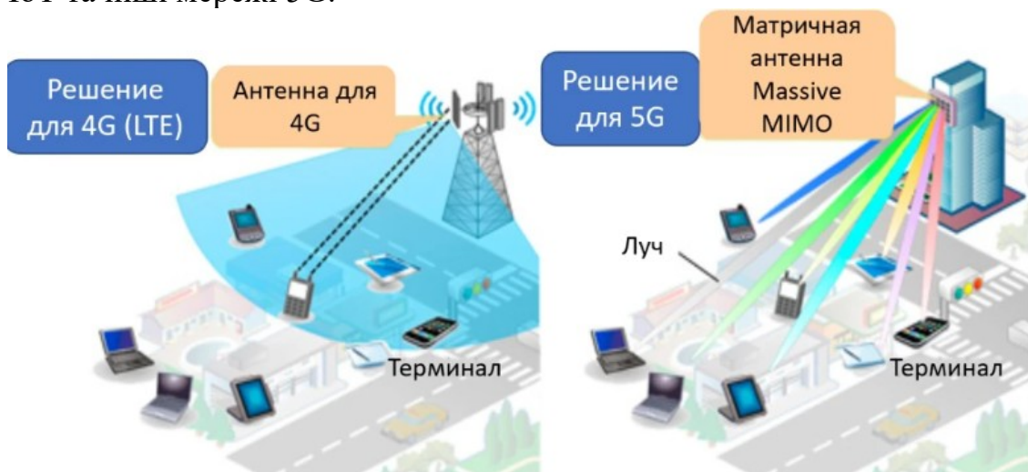
Рис. 1.4 Порівняння рішення Massive MIMO в мережах 5G з антенами для мереж 4G [6]
