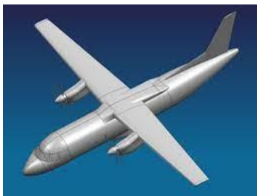
Рисунок 1.5 – Приклад поверхневої 3D моделі
