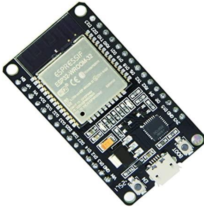
Рисунок 2.7 – Загальний вид мікроконтролера ESP-NOW - PTP ESP32
