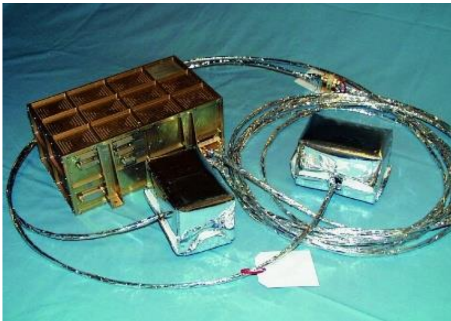
Рисунок 3.2. Інструменти FGM Cluster перед їх монтуванням. Зображення є власністю Європейського космічного агентства.
