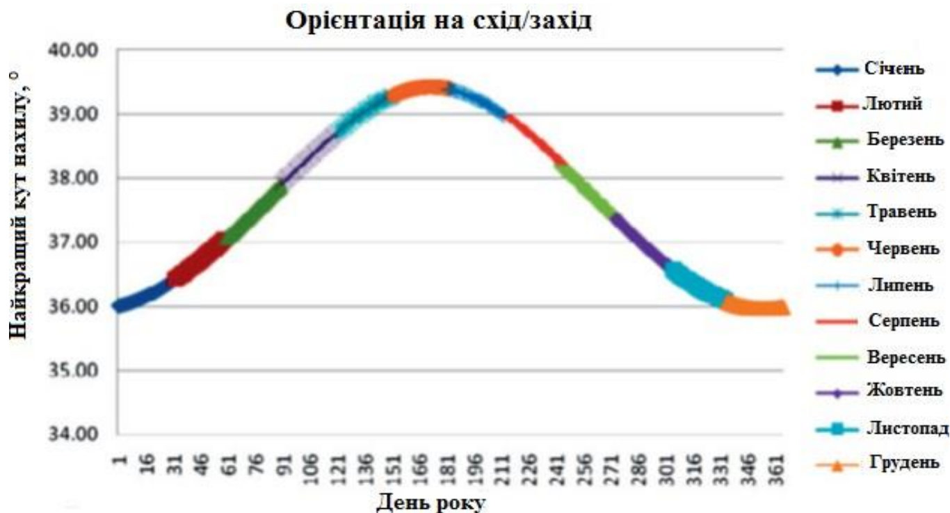
Рис. 1.24. Оптимальний кут нахилу сонячного колектора, встановленого в м. Сурабая (Індонезія) з орієнтацією вранці на схід та ввечері на захід [26]
