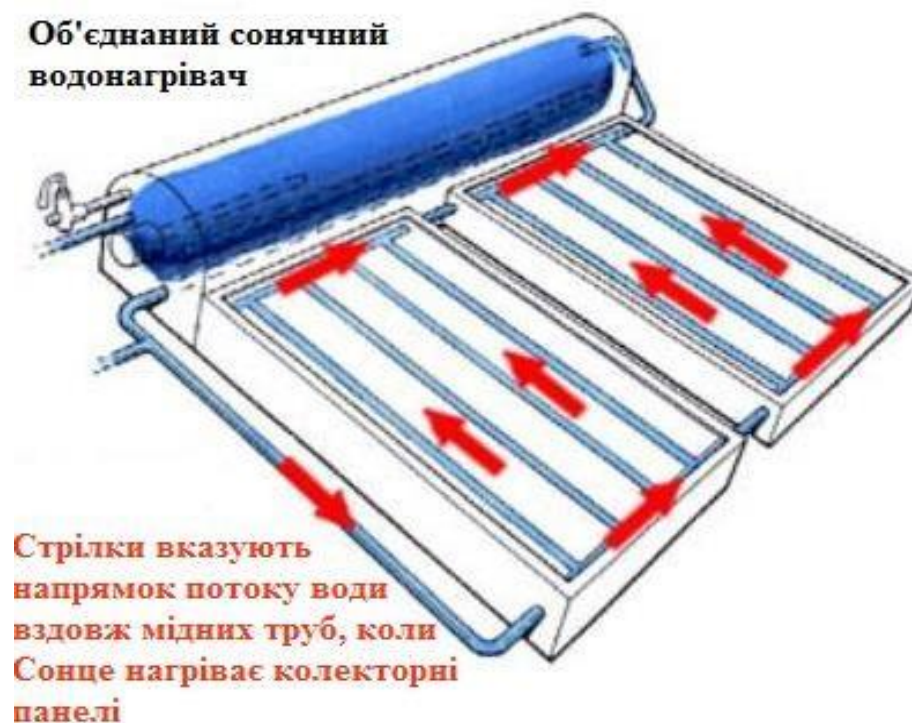
Рис.1.32. Об'єднаний сонячний водонагрівач [44]
