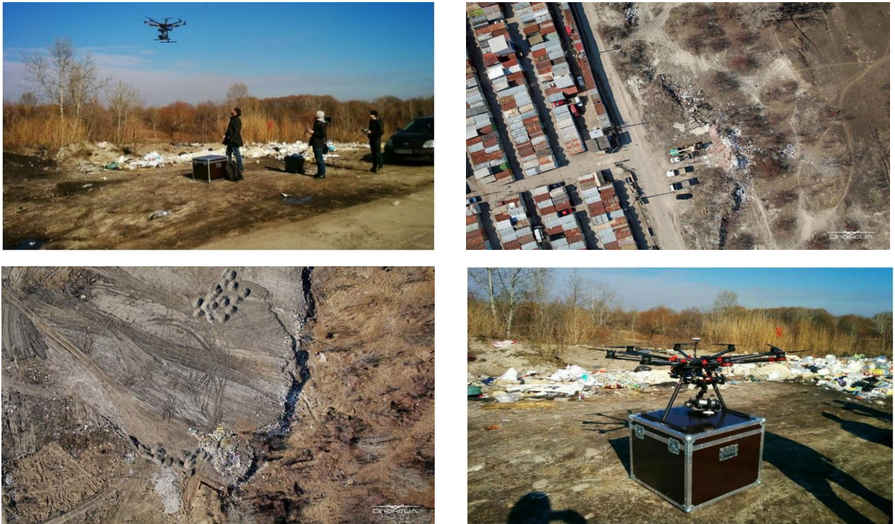
Рис. 4.7. Виявлення даних про несанкціоновані звалища за допомогою дронів
