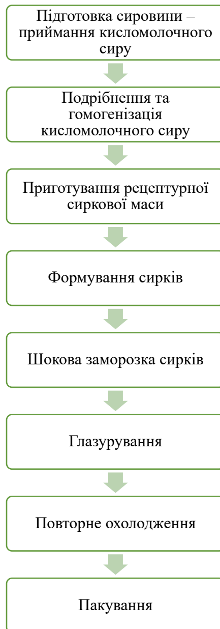
Рис. 3.3. Технологічний процес виробництва глазурованих сирків.
