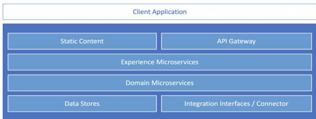
Рисунок 2.1 – Архітектура мікросервісного веб-додатку
