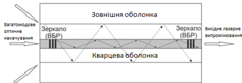
Рис. 1. Спрощена схема волоконного лазера
