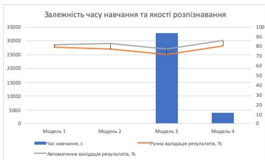
Рисунок 3.2 – Графік залежності часу навчання та якості розпізнавання для різних моделей навчання згорткової нейронної мережі для зображень 299x299 пікселів
