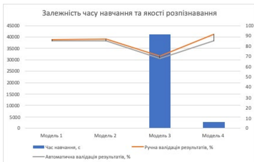
Рисунок 3.4 – Графік залежності часу навчання та якості розпізнавання для різних моделей навчання згорткової нейронної мережі для оригінальних зображень
