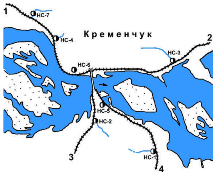
Рис. 3.7. Схема захисних споруд м. Кременчук: 1 – Західно-Кременчуцька, 2 – Східно-Кременчуцька, 3 – Західно-Крюківська, 4 – Східно-Крюківська дамби.
