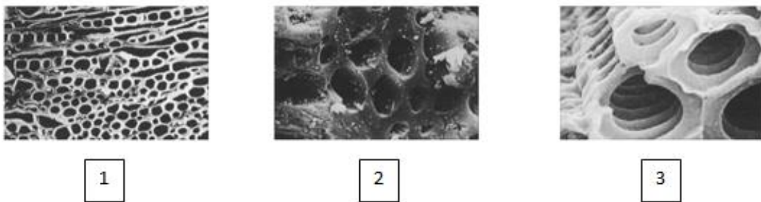
Рис. 1.2. Структура пор активованого вугілля на основі різної вихідної сировини: 1 – деревина, 2 – кам'яне вугілля, 3 – кокосове вугілля.
