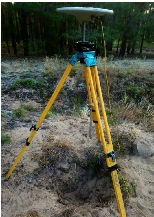
Рис. 2.3. Процес застосування GNSS-приймача Trimble Zephyr 3 під час виконання робіт з демаркації державного кордону
