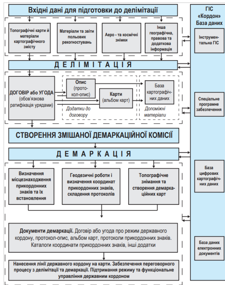
Рис. 2.2. Схеми процесу картографо-геодезичного забезпечення встановлення державного кордону
