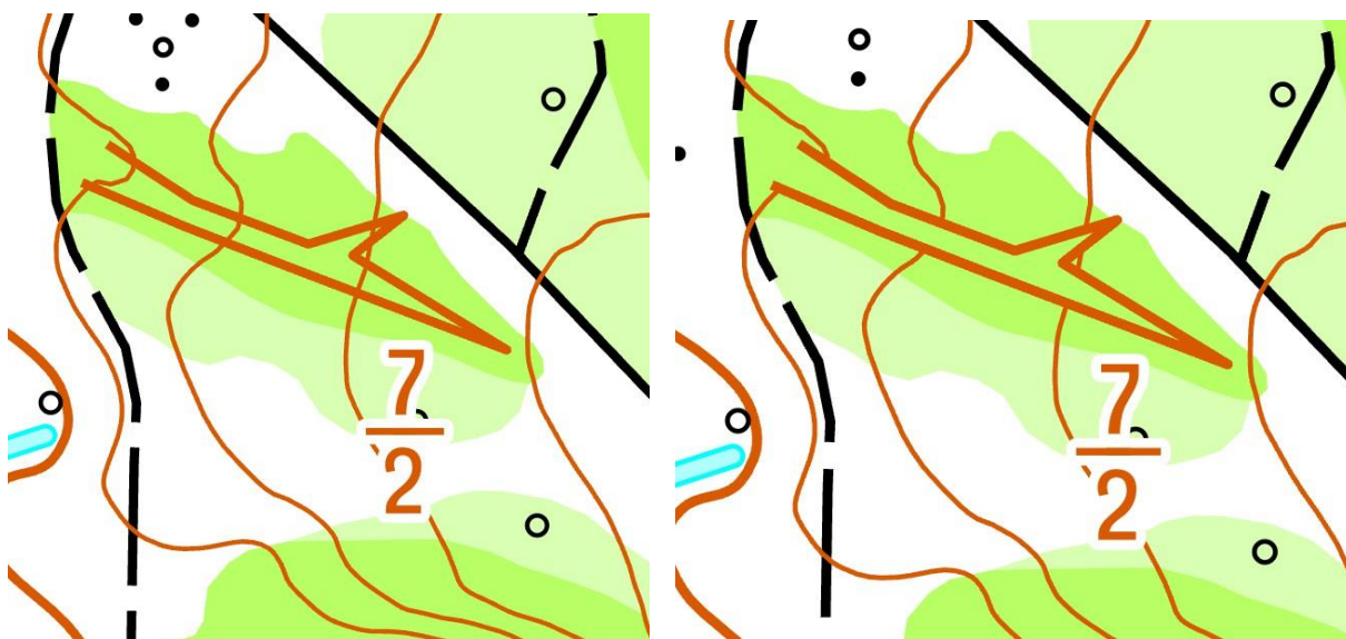
Рис. 3.4. Порівняння відображення елемента рельєфу (промоїни) з маскою та без маски
