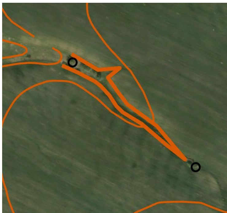
Рис. 3.3. Правильне нанесення промоїни
