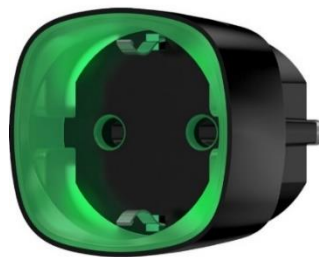
РИСУНОК 1.30 - Радіокерована розумна розетка з лічильником енергоспоживання Ajax Socket
