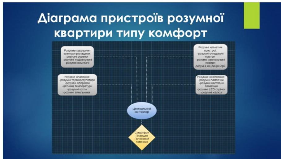
РИСУНОК №Б.4 – Діаграма пристроїв розумної квартири типу комфорт
