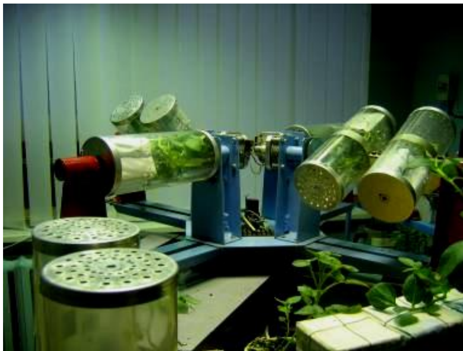
Рис. 3.4.1. Вирощування рослин картоплі у кліноостаті «Цикл-2» за умов модельованої мікрогравітації
