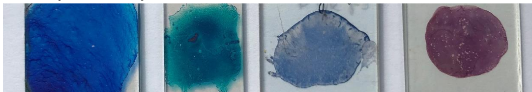
Рис.2.8 Фотографія зразків з вільною поверхнею ФПК на основі ГКБЕ та барвників: 1- СК-1; 2- СК-2; 3- СК-3; 4- МЦ-1
