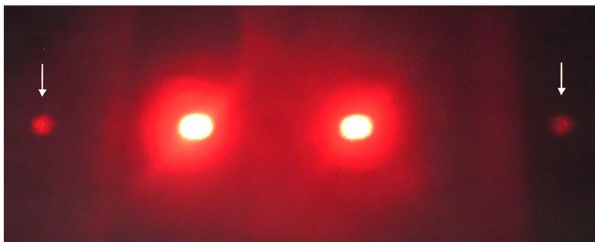
Рис.3.7 Відновлена голограма плоского хвильового фронту (ПХФ), записана в плівці ФПК на основі ГКБЕ + 1 мас.% МЦ-2. Для запису використовувався напівпровідниковий лазер з довжиною хвилі випромінювання 650 нм і потужністю 5 мВт, \omega = 400 мм -1 при відношенні інтенсивностей опорного і об'єктного променів 1:1. (Товщина ФПК 1 мкм) Стрілками показані перші порядки дифракції, \eta = 0,15\% .
