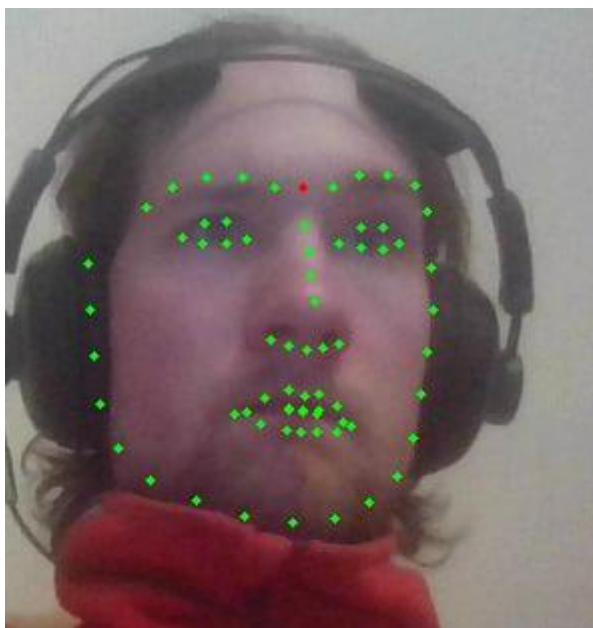
Рисунок 2. 2 - Приклад активної моделі зовнішнього вигляду обличчя
