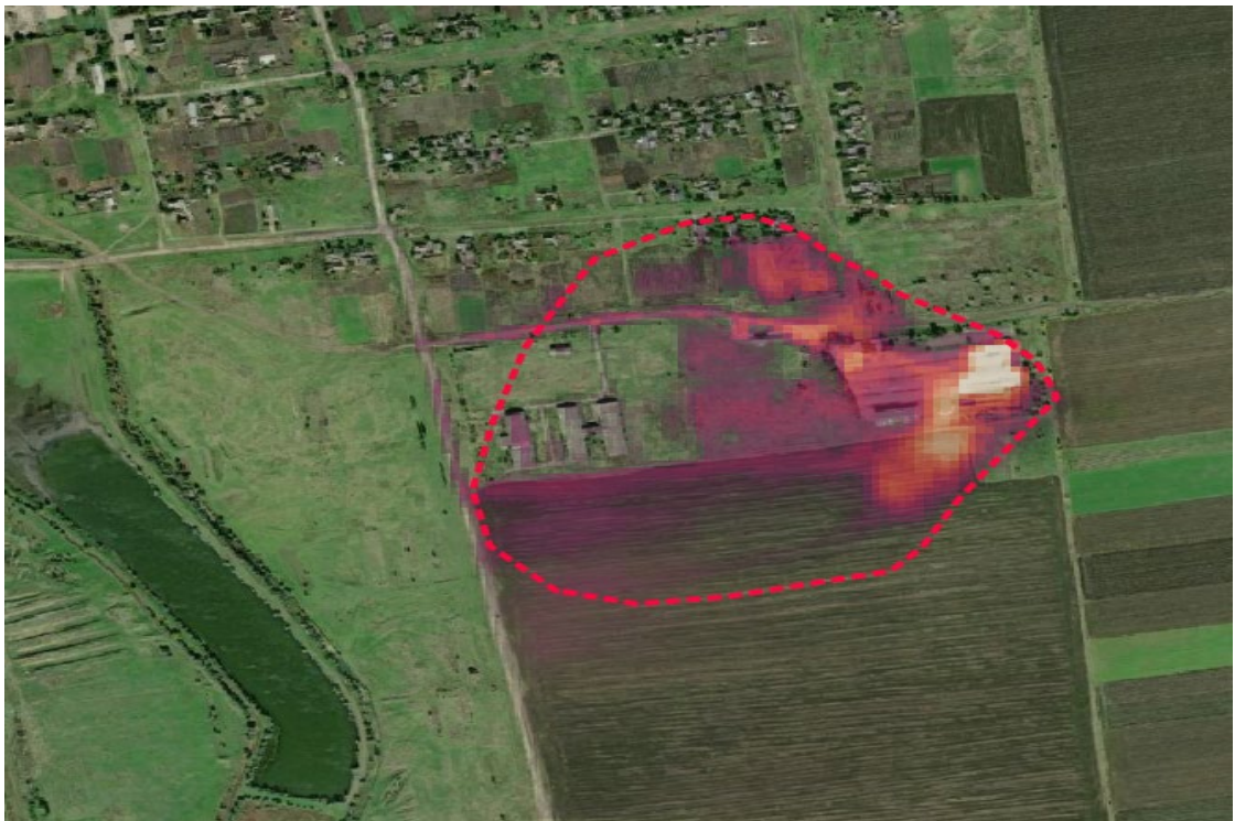
Рис. 2.5. Приблизна зона розповсюдження хімікатів внаслідок вибуху складу з селітрою. Оброблене зображення супутниковому знімку Sentinel-2 (ESA) (на якому видно наслідки вибуху) накладено на супутниковий знімок високого розділення Махар (ESRI)
