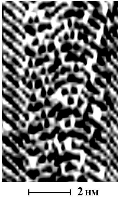
Рис.14 Скануюча тунельна мікроскопія напівпровідникової нанотрубки. Просторова роздільна здатність 0.06 нм.
