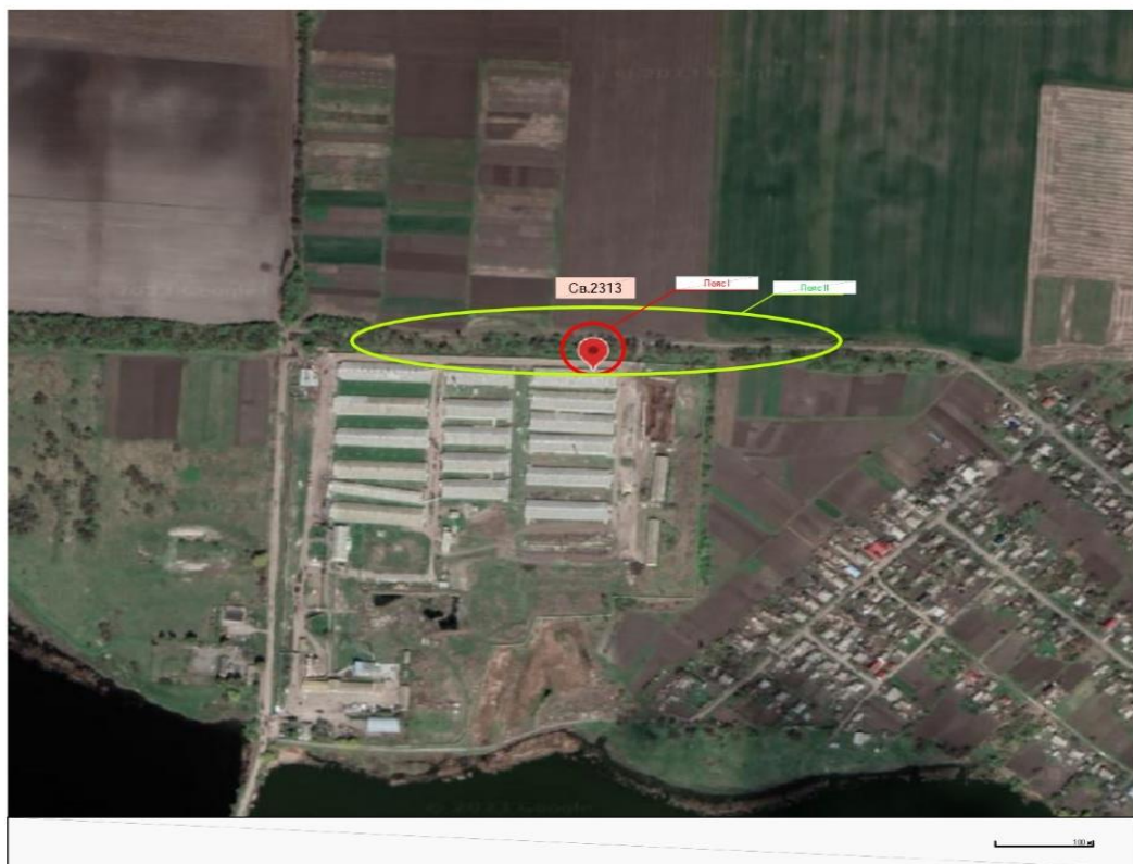
Мал. 2.8 Схема I-го та II-го поясів зони санітарної охорони в умовах ухилу підземного потоку відносно водозабірної свердловини №2313
