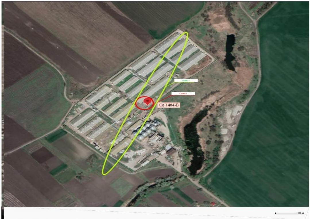
Мал. 2.7 Схема I-го та II-го поясів зони санітарної охорони в умовах ухилу підземного потоку відносно водозабірної свердловини №1484-В
